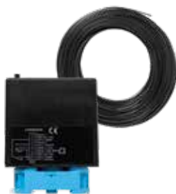
Inductielus Inductielusdetector met maak- en wisselcontact, instelbaar op impuls- of permanent contact, richtingsherkendend, luskabel 50 m
