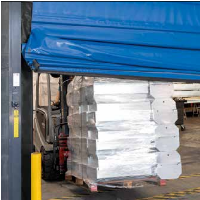
Geen uitval na een aanrijding dankzij de innovatieve flexibele geleidingsbanden
