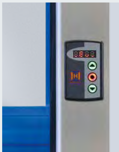
Comfortabele bediening met optioneel besturingselement (80 x 120 mm) voor integratie in het zijdelings kozijn op een hoogte van 1300 mm
