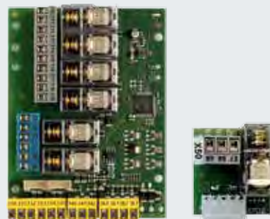
Uitbreidingsprintplaat voor de besturingen: BK 150 FU E-1 (E FU H) AK 500 FUE-1 (E FU H)
